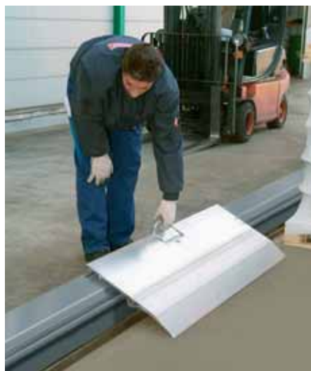
Край моста положить на рабочую поверхность, вставив соединительный элемент в шину.
